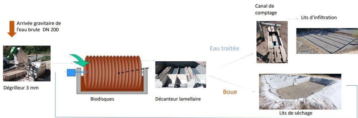
Figure 49 : Synoptique de traitement de la nouvelle STEP du pigeonnier basée sur des bioprocédés avancés pour traiter les effluents du Hameau du pigeonnier avec une capacité de 350 EH.
